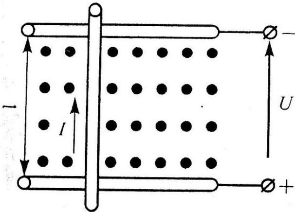
Проводник с током  $I=5 \text{ А}$ , сопротивлением  $r_0=0,2 \text{ Ом}$  и длиной  $l=1 \text{ м}$  находится в однородном магнитном поле с магнитной индукцией  $B=1,1 \text{ Тл}$ . Он присоединен к сети напряжением  $U=12 \text{ В}$ . В результате взаимодействия тока в проводнике и магнитного поля. Определить противо-ЭДС  $E_{пр}$ , наводимую в проводнике, скорость его движения  $V$ , электромагнитную силу  $F_{эм}$  и ток в остановленном проводнике  $I_{ост}$ . Составить уравнение баланса
