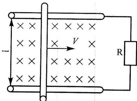
В однородном магнитном поле с магнитной индукцией  $B = 1$  Тл находится проводник длиной  $L = 1$  м и током  $I = 8$  А. проводник присоединен к сети напряжением  $U = 10$  В. В результате взаимодействия тока в проводнике и магнитного поля он движется со скоростью  $V$ , перпендикулярно к направлению поля. Развиваемая при этом механическая мощность  $P_{мех} = 50$  Вт. Определить противо-
