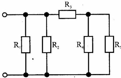
Определить: эквивалентное сопротивление, токи и напряжения на каждом участке, силу тока всей цепи.
