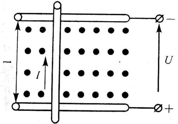
На рисунке показать направление противо-ЭДС и электромагнитной силы.
