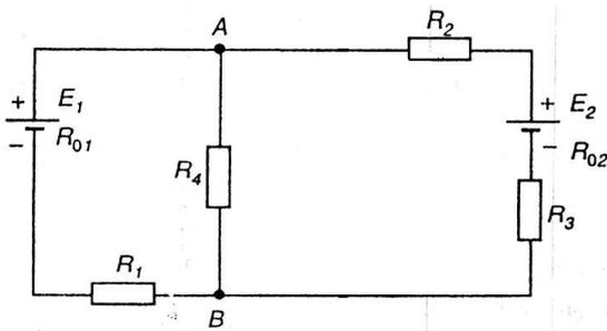
В сложной электрической цепи  $E_1=30 \text{ В}$ ,  $E_2=40 \text{ В}$ ,  $R_1=10 \text{ Ом}$ ,  $R_2=2 \text{ Ом}$ ,  $R_3=3 \text{ Ом}$ ,  $R_4=12 \text{ Ом}$ ,  $R_{01}=2 \text{ Ом}$ ,  $R_{02}=1 \text{ Ом}$ .
