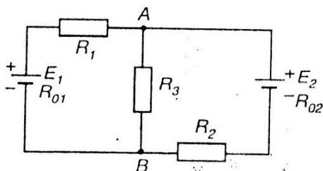
В сложной электрической цепи  $E_1=150$  В,  $E_2=170$  В,  $R_1=29,5$  Ом,  $R_2=24$  Ом,  $R_3=40$  Ом,  $R_{01}=0,5$  Ом,  $R_{02}=1$  Ом.
