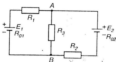
В сложной электрической цепи  $E_1=150$  В,  $E_2=170$  В,  $R_1=29,5$  Ом,  $R_2=24$  Ом,  $R_3=40$  Ом,  $R_{01}=0,5$  Ом,  $R_{02}=1$  Ом.
