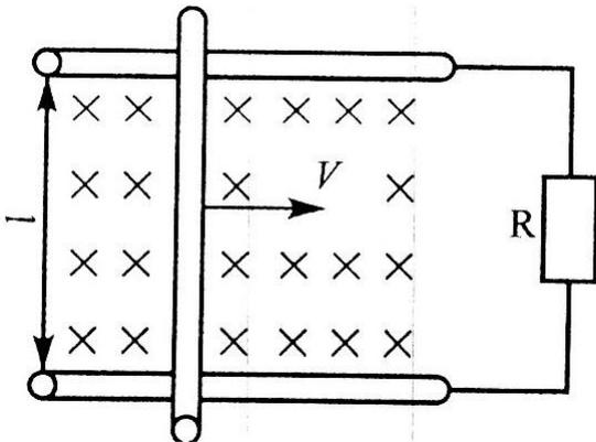
В однородном магнитном поле с магнитной индукцией  $B = 1$  Тл находится проводник длиной  $L=1$  м и током  $I=8$  А. проводник присоединен к сети напряжением  $U=10$  В. В результате взаимодействия тока в проводнике и магнитного поля он движется со скоростью  $V$ , перпендикулярно к направлению поля. Развиваемая при этом механическая мощность  $P_{мех}=50$
