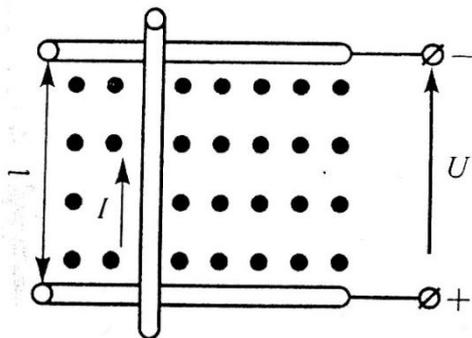
В однородном магнитном поле с магнитной индукцией  $B=1,2$  Тл перпендикулярно к направлению поля со скоростью  $V=8$  м/с движется проводник длиной  $l=1$  м. проводник с сопротивлением  $R=0,5$  Ом присоединен к источнику питания напряжением  $U=10$  В. Определить наводимую противоЭДС<sub>пр</sub>, ток в движущемся проводнике
