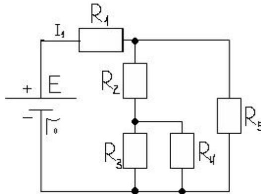
Определить: эквивалентное сопротивление, токи и напряжения на каждом участке, силу тока всей цепи.
