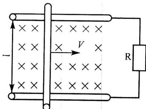
В однородном магнитном поле с магнитной индукцией  $B=1,8\text{ Тл}$  перпендикулярно к направлению поля со скоростью  $V=8\text{ м/с}$  движется проводник длиной  $l=25\text{ см}$  и сопротивлением  $r_0=0,8\text{ Ом}$ . Проводник замкнут на сопротивление  $R=1,2\text{ Ом}$ .
