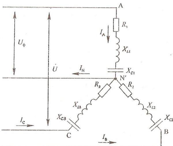
Исходные данные:  $U_{\text{л}}=80$  В,  $R_1=4$  Ом,  $X_{C1}=3$  Ом,  $R_2=3$  Ом,  $X_{L2}=4$  Ом,  $R_3=4$  Ом.
